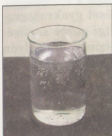
18. ábra A vízben oldott levegő buborék- jainak megjelené- se a melegítés hatására
