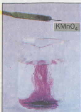
13. ábra A színes \text{MnO}_4^- ionok diffúziója a kálium- permanganát oldódásakor a vízben
