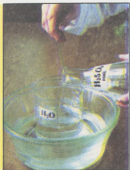
14. ábra A híg kénsavoldat helyes elkészítési módja
